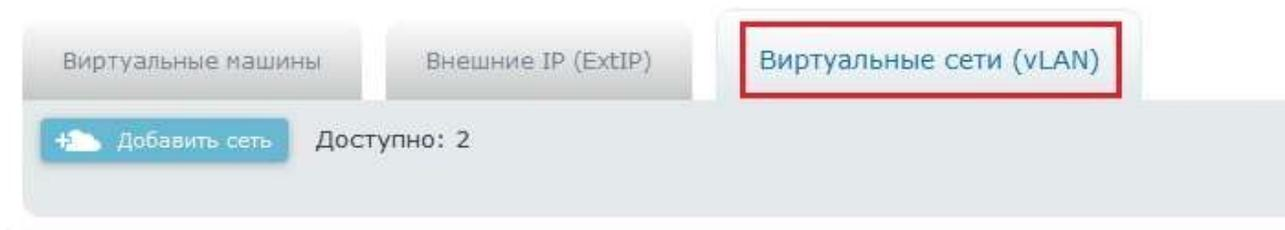
«Серые» IP адреса, также как и «Реальные» можно присвоить ВМ **автоматически только** в случае создания новой машины и разворачивание ее из *шаблона*! Для этого нужно создать виртуальную сеть (если еще не создавали). В нашем примере мы будем использовать уже созданную сеть с именем «**Local**».
